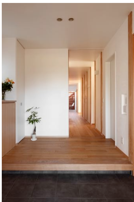
玄関框と真壁の柱は昔の家のものを削り直して使っています。
